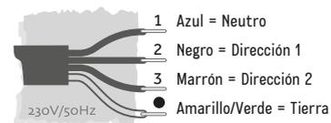
Conexión motor mecánico
