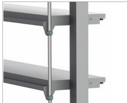
Testerías y ejes de aluminio, fijadas a la lama con dos tornillos de acero inoxidable. Un pasamanos tubular de 10 mm de diámetro asegura un buen cierre y garantiza la perfecta alineación de las lamas. Se puede fabricar con el pasamanos a la derecha o a la izquierda de la celosía.
