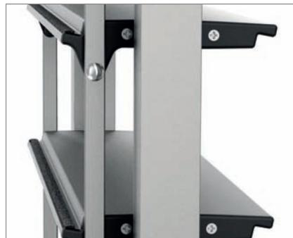
Testerías inyectadas en poliamida 6,6 reforzada con fibra de vidrio (opcionalmente en aluminio) y eje de aluminio; fijadas a la lama con dos tornillos de acero inoxidable. Doble pasamanos de accionamiento que aseguran un buen cierre y garantizan la perfecta alineación de las lamas.
