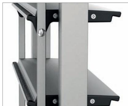
Testeras inyectadas en poliamida 6,6 reforzada con fibra de vidrio (opcionalmente en aluminio) y eje de aluminio, fijadas a la lama con dos tornillos de acero inoxidable. Doble pasamanos de accionamiento que aseguran un buen cierre y garantizan la perfecta alineación de las lamas.
